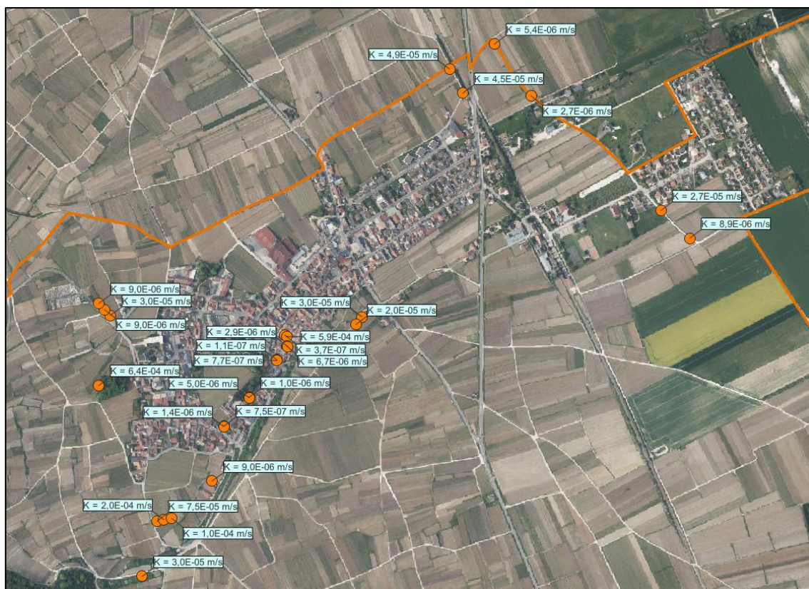
Figure 28 : Résultats des tests de perméabilité réalisés par la CAEPC
