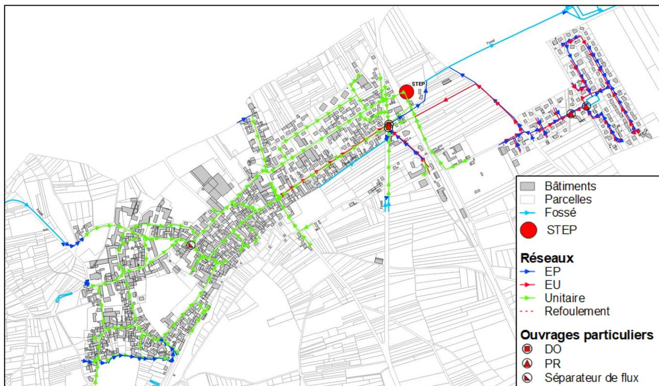
Figure 35 : Extrait du plan des réseaux d'assainissement à Le Mesnil sur Oger
