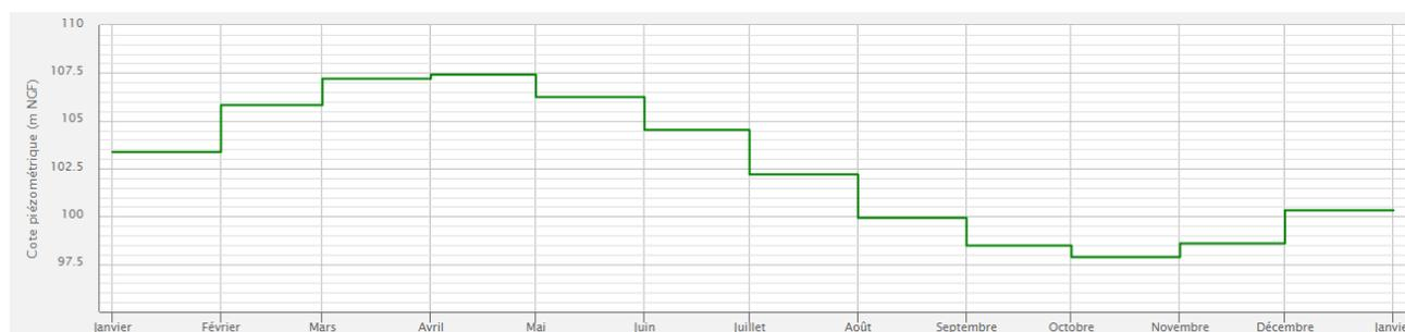
Figure 13 : Evolution de la cote moyenne mensuelle de la nappe de la craie au droit du piézomètre BSS000PTLZ
