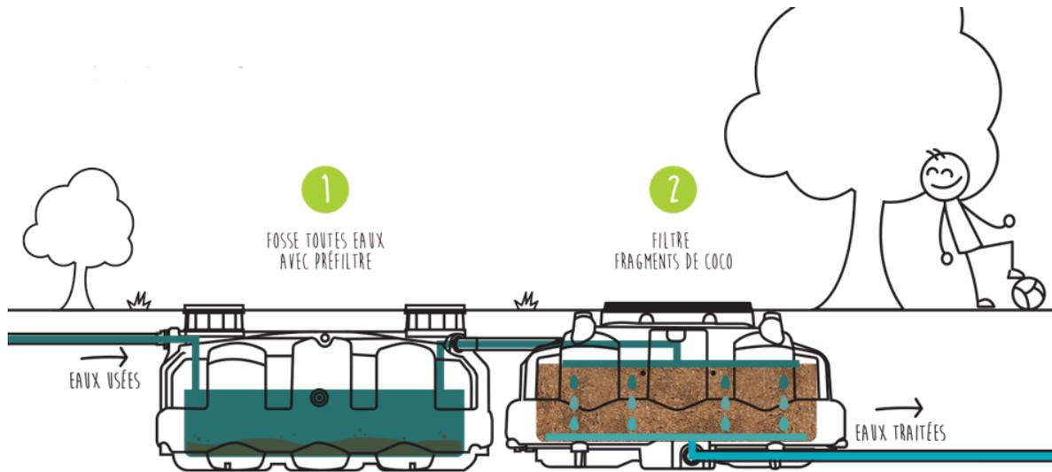
Le massif filtrant (zéolithe, copeaux de coco, laine de roche, sable, etc.) reçoit l'ensemble des eaux usées domestiques prétraitées (effluents septiques).
