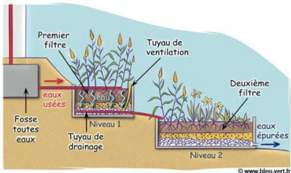
Ces dispositifs permettent d'assurer le traitement des eaux usées domestiques selon le principe de la culture fixée sur des supports filtrants.
