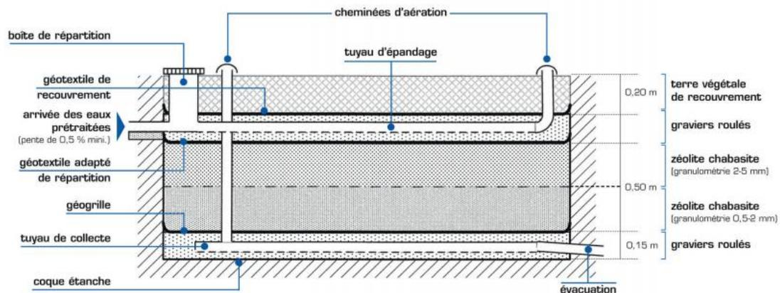
A installer notamment dans le cas des sols de perméabilité trop faible et en cas de surfaces disponibles réduites. De la zéolite est utilisée comme support à l'épuration (traitement). Les eaux usées traitées sont drainées pour être évacuées vers un exutoire.
