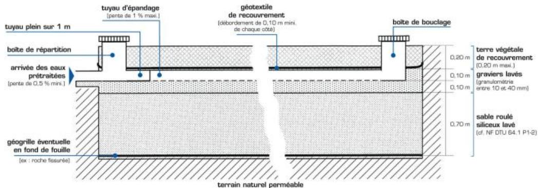
A installer notamment dans le cas des sols de perméabilité trop élevée. Du sable lavé est utilisé comme support à l'épuration (traitement) et le sol en place comme moyen dispersant (évacuation).
