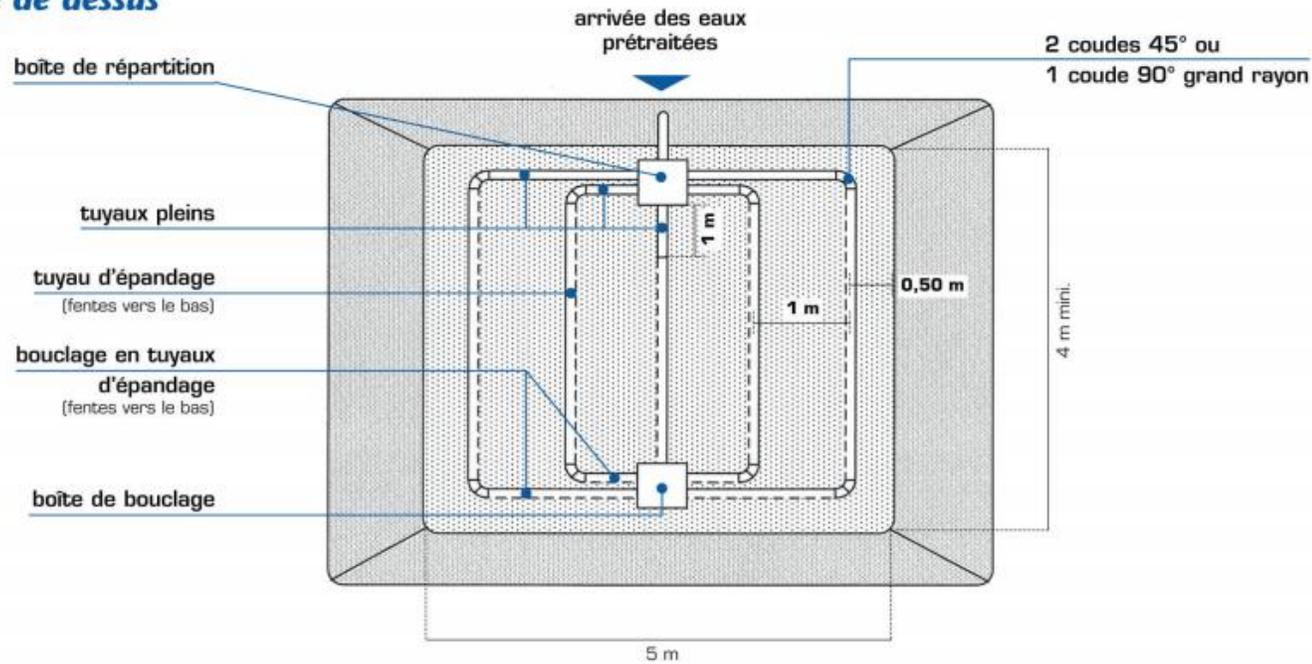
Le terre est un dispositif hors sol non drainé, qui nécessite généralement le relevage des eaux. Il utilise le sable comme support à l'épuration (traitement) et le sol comme milieu dispersant (infiltration).
