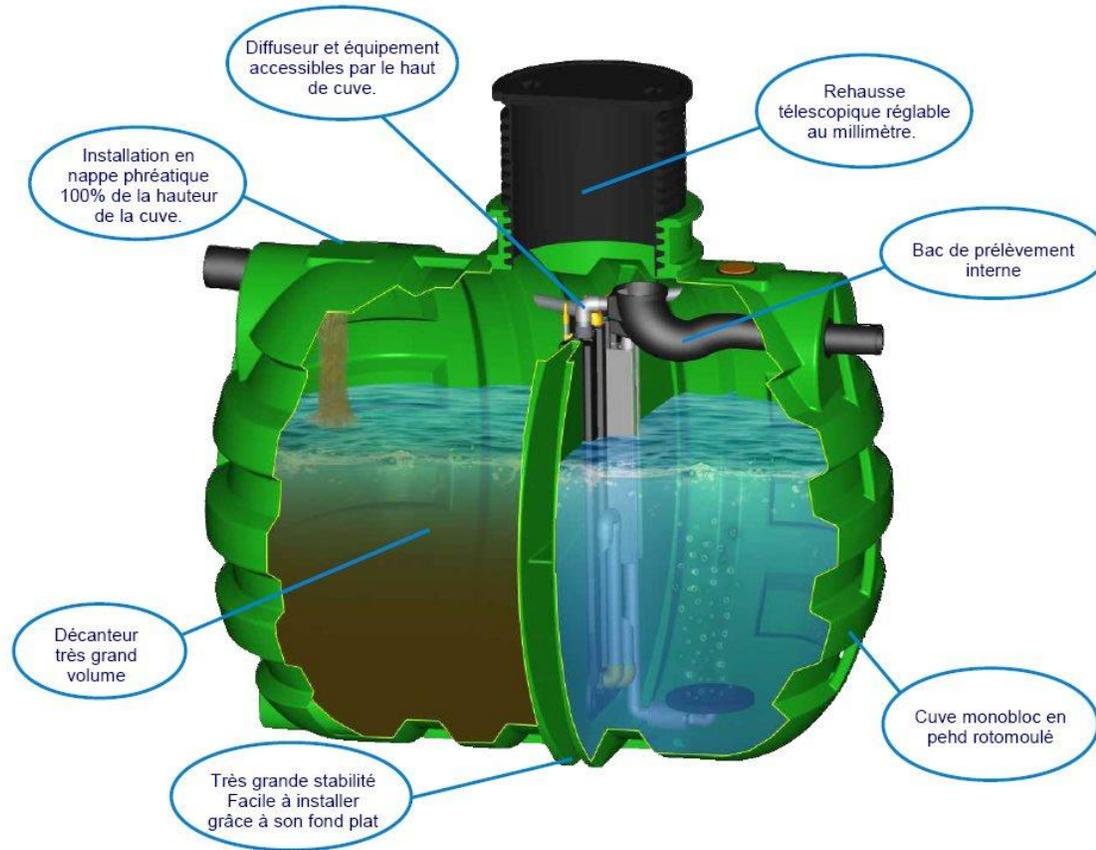
Ces dispositifs permettent d'assurer le traitement des eaux usées domestiques selon le principe de la dégradation aérobie (avec oxygène) de la pollution par des microorganismes (bactéries) en culture libre.
