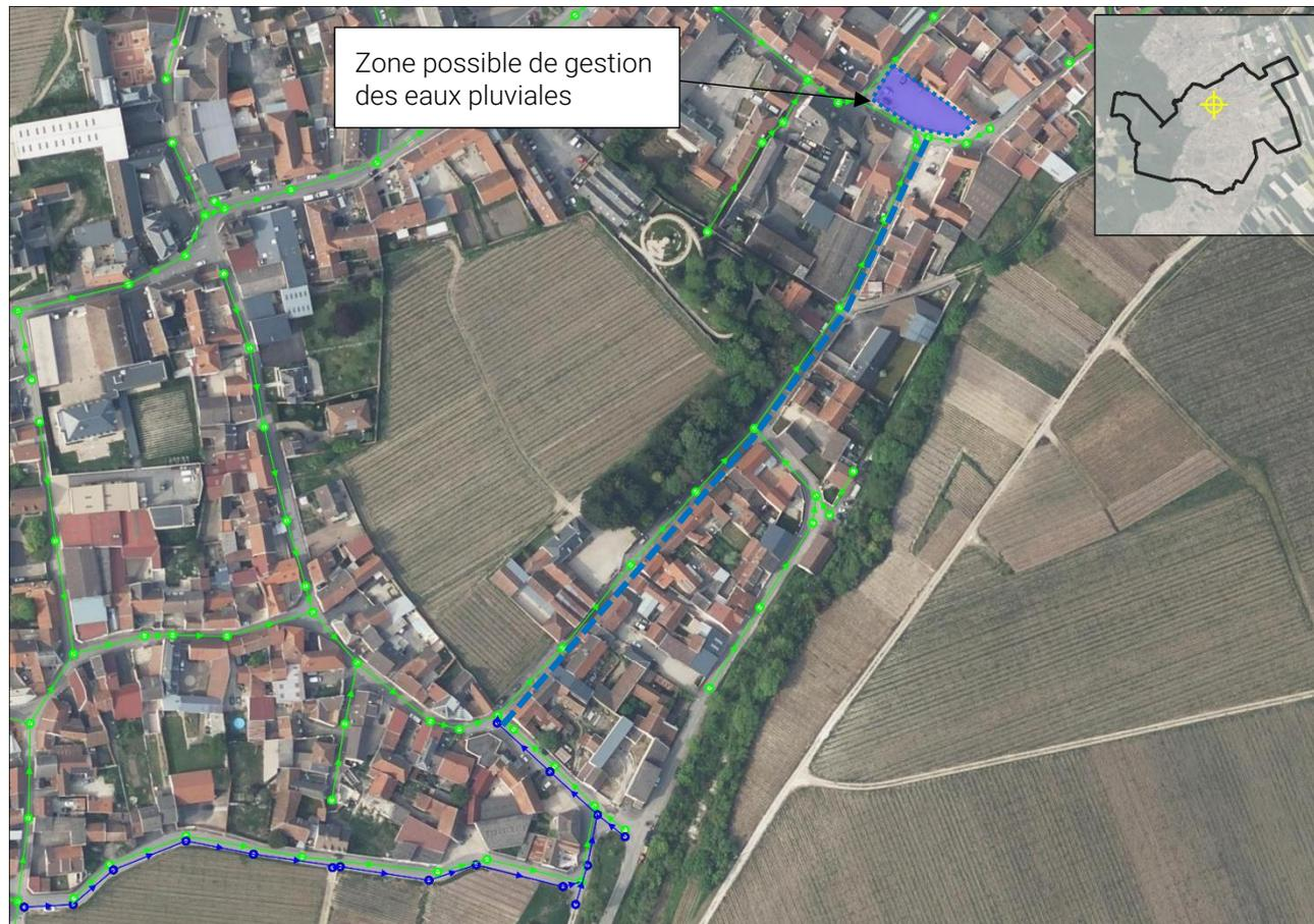
Figure 3 : Proposition de l'extension du réseau EP rue Pasteur
