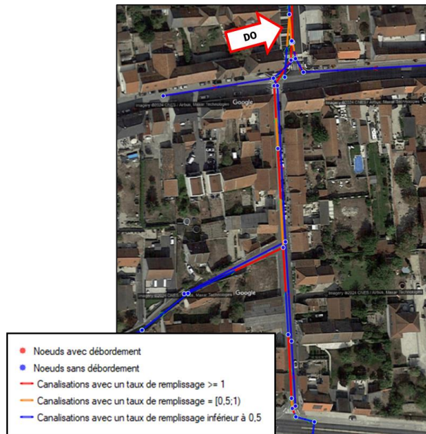
Figure 8 : Cartographie des réseaux en charge dans le BV Centre 1 pour une pluie annuelle
