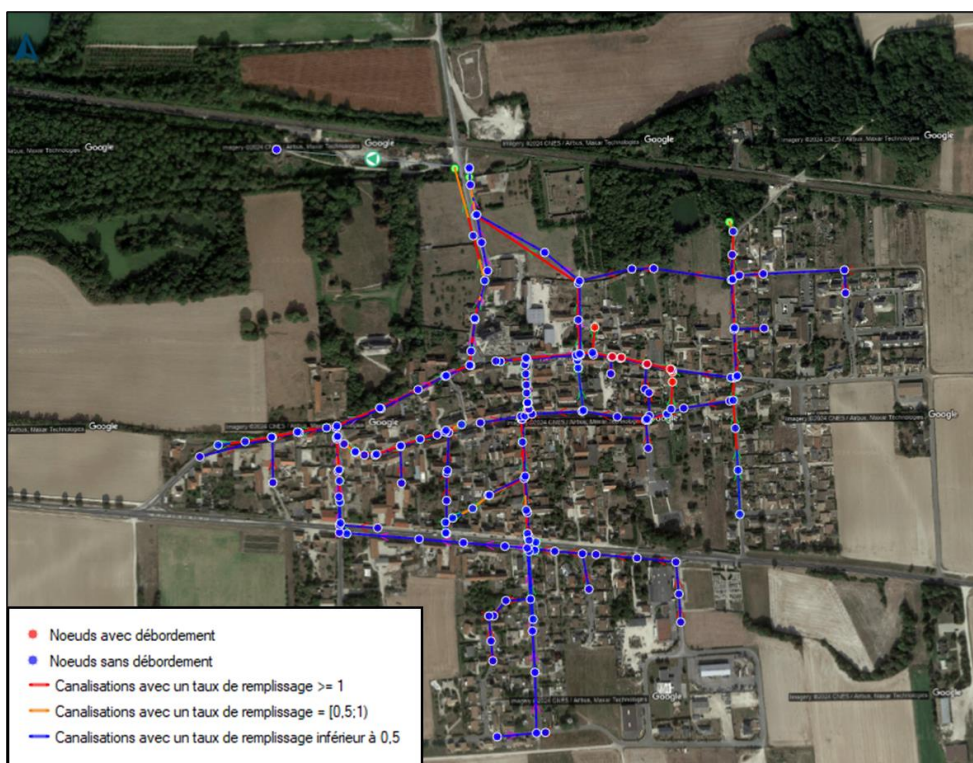
Figure 19 : Cartographie des débordements pour une pluie cinquantennale après la suppression du DO et la déconnexion des logements individuels
